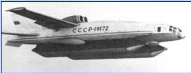
Предусматривалась постройка двух СВВП: ВВА-14-1М для исследований аэродинамической компоновки и систем на самолетных режимах и ВВА-14-2М для исследований вертикального взлета и посадки и переходных процессов. В июне 1972 г. была завершена постройка первого самолета ВВА-14-1М без подъемных двигателей и поплавков и в июле на аэродроме ТАНТК начались рулежные испытания самолета, оснащенного колесным шасси, и подлеты, а 4 сентября 1972 г. состоялся первый полет с взлетом и посадкой по-
