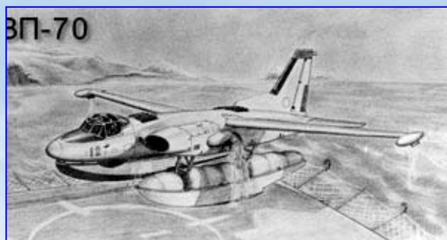
СВВП выполнен по схеме высокоплана с составным крылом из несущего центроплана и отъемных консолей, оснащенных элеронами и закрылками. На стоянке консоли крыла складывались назад.
