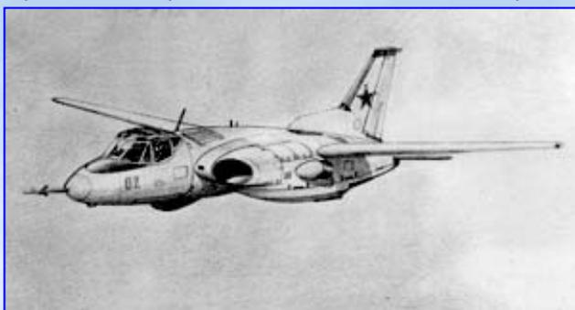
Самолёт предполагалось оснастить четырьмя подъёмными двигателями РД-36-35Ф, установленными попарно в продолговатом фюзеляже спереди и сзади. В качестве подъёмно-маршевых предполагалось использовать два АИ-25, оснащённых поворотными соплами, расположенными близко к центру тяжести самолета.
